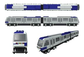
capacité de 222 passagers et pèsent 55 tonnes. Composées de deux automotrices, elles mesurent 30.68 mètres de longueur par 2.45 mètres de largeur. Afin de franchir les pentes Afin de franchir les pentes importantes du tracé, elles roulent sur pneus et sont propulsées par un courant continu de 750 volts délivré par le rail de quidage.
